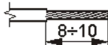
Die Länge der Muffen an den Kabelenden (Länge des isolierten Teils des Kabels) sollte 8÷10mm betragen. Kürzere Enden – z. B. 6 mm – können aus der Verbindung herausrutschen.
