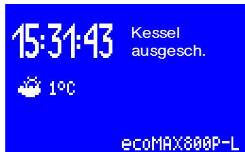
Abb. 5 Reglerdisplay bei ausgeschaltetem Kessel
