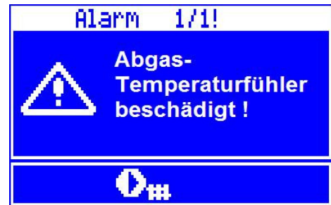
Abb. 43 Alarm – Beschädigung des Abgasfühlers
