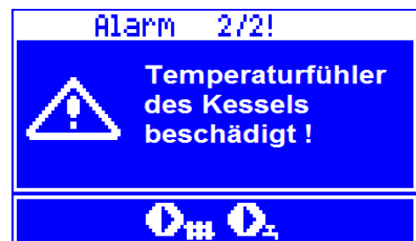
Abb. 45 Ansicht des Alarmkommunikats „Beschädigung des Kessel-Temperaturfühlers“.
