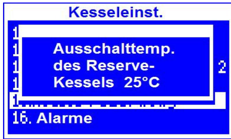
Abb. 35 Einschaltung der Steuerung des Reservekessels.
