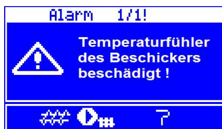
Abb. 46 Ansicht des Alarmkommunikats „Beschädigung des Beschicker-Temperaturfühlers“.
