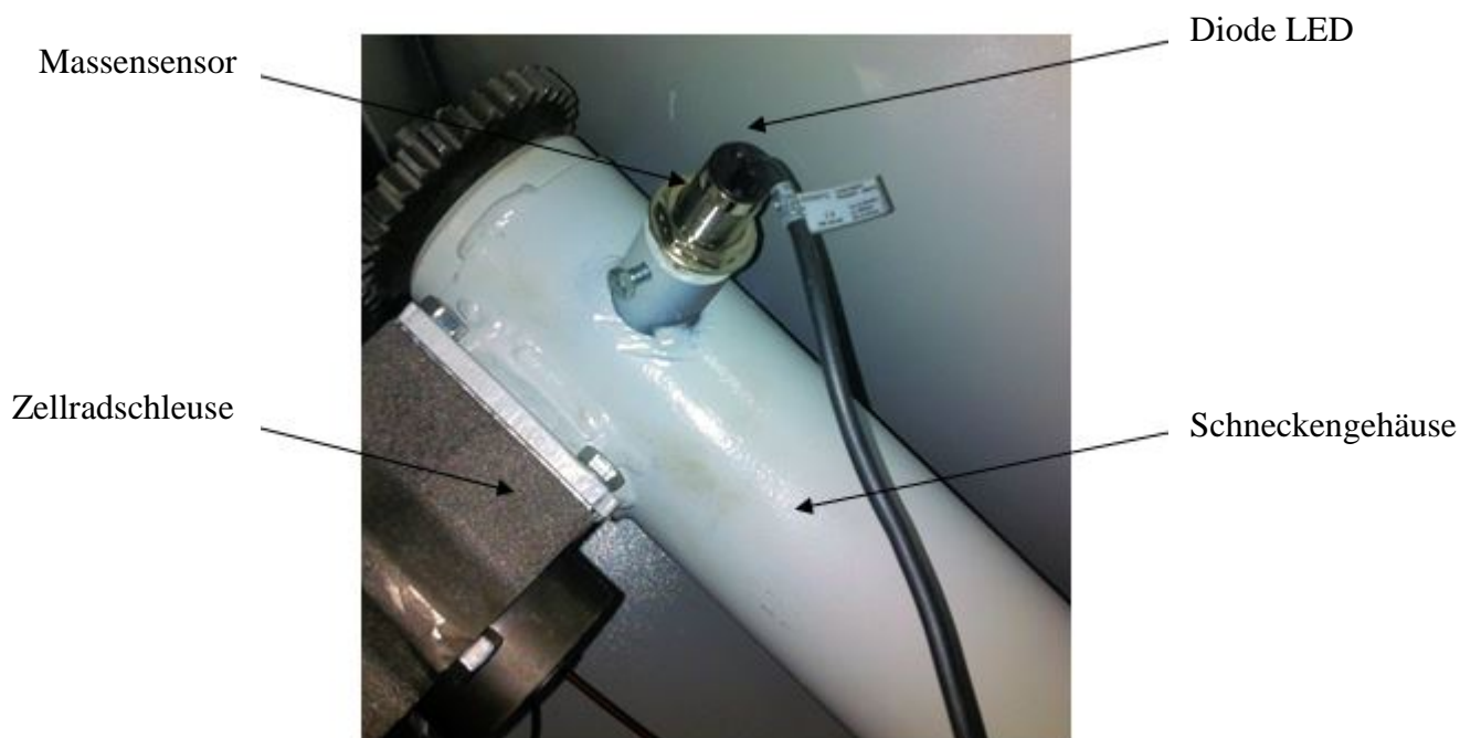
Abb. 5. Platzierung des Massensensors auf dem Schneckengehäuse
