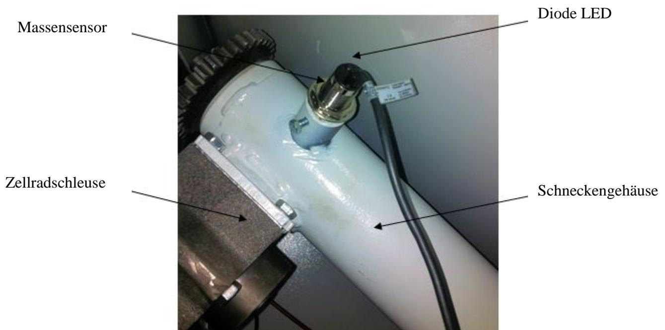
Abb. 5. Platzierung des Massensensors auf dem Schneckengehäuse
